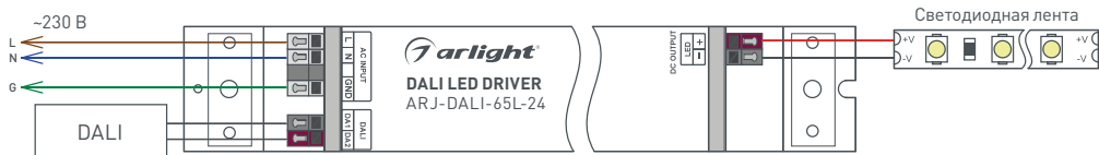
Рис. 1. Подключение источника напряжения при использовании интерфейса DALI.
