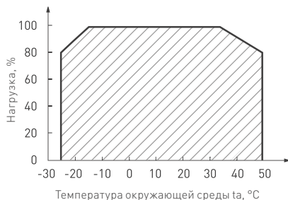
Рис. 2. Максимальная допустимая нагрузка, % от мощности источника.
