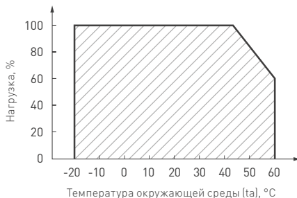
Рис. 2. Максимальная допустимая нагрузка, % от мощности источника.
