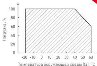
Рисунок 6. Максимальная допустимая нагрузка, % от мощности источника.
